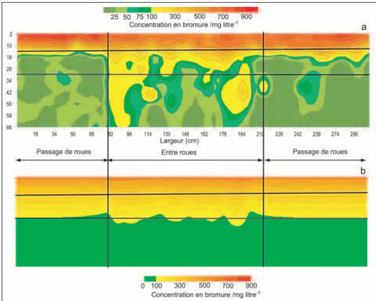
**Figure 7** - Profils de concentration en bromure mesurés comparés aux profils simulés à l'aide d'HYDRUS-2D et en utilisant les paramètres hydriques modifiés (tableau 1).
